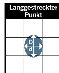
Bei der Kennzeichnung und beim Lesen können Codeverzerrungen auftreten. Diese sind so weit wie möglich zu vermeiden. Der Winkel zwischen X- und Y-Achse beträgt idealerweise 90°. Eine Abweichung von bis zu 7° ist tolerierbar.
