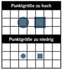
Hiermit wird der Füllgrad eines Punktes geprüft.                                                                                                                 |                                                     | 60 % ... 105 %                                                     |         | •                                                                                        |
